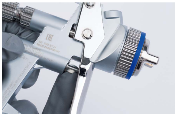
图31 在扳机顶杆涂抹润滑油
