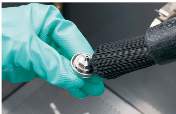
图19 清洗喷嘴表面
