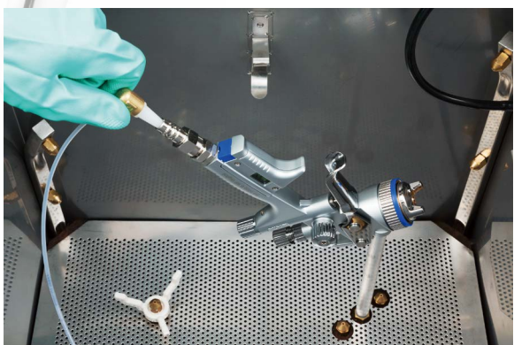
图15 将塑料管插入喷枪进气口
