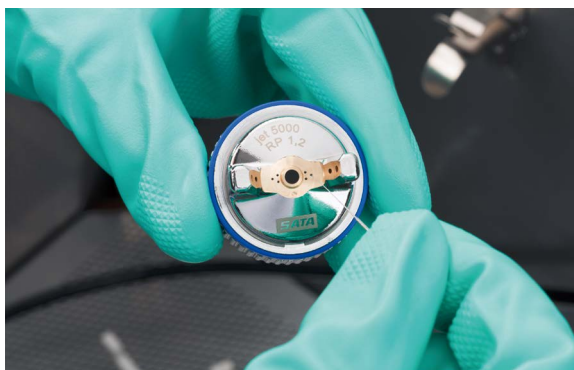
图18 清洗辅助雾化孔和扇面控制孔
