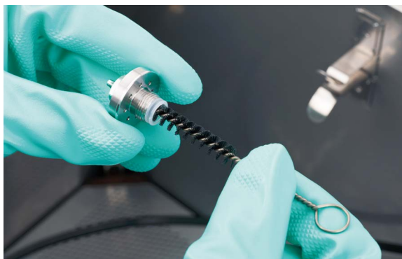
图20 清洗喷嘴涂料通道
