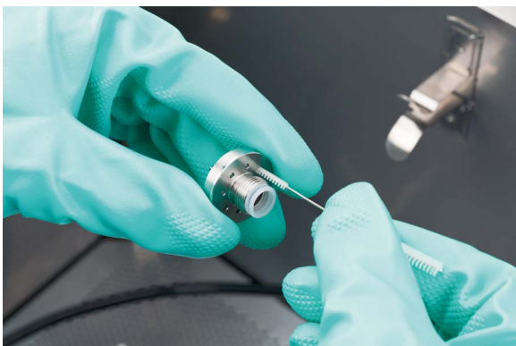
图21 清洗喷嘴上的通气孔
