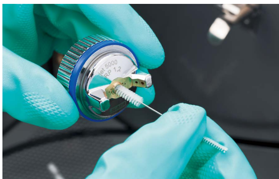
图17 清洗风帽雾化孔
