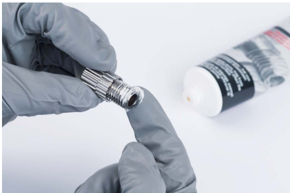
图29 在螺纹处涂抹润滑油
