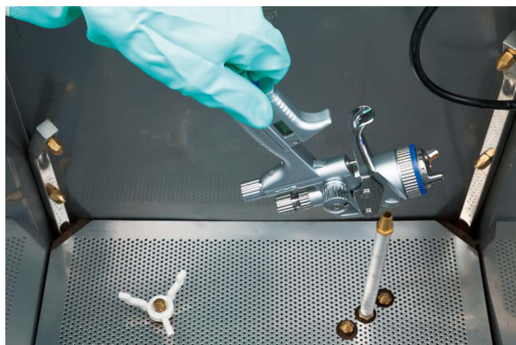
图14 喷壶接口插入喷射管
