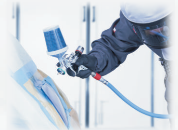
标准型 120 (HVLV) 和 110 (RP) 喷嘴适合小面积、小工件、附件、小家居件的喷涂
